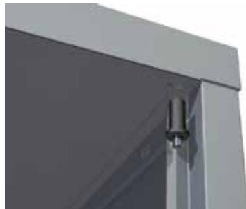
13. Самую верхнюю дверь надеть нижним отверстием на нижнюю ось. Затем «утопив» подпружиненный металлический наконечник верхней оси, завести дверь под верхнюю ось и совместить соответствующее отверстие в двери с осью до выщелкивания наконечника.
