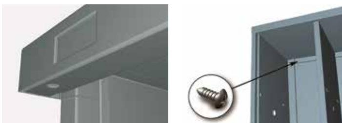
9. Установить перегородки. Установку перегородок рекомендуется начинать с самой верхней. Верхние перегородки отличаются от нижних наличием на верхней отбортовке двух прямоугольных отверстий. Верхнюю перегородку завести верхней отбортовкой под фиксирующую полосу крыши и задвинуть до защелкивания замков. Затем соединить верхнюю перегородку с нижней с помощью двух винтов M5x10 с гайками (сквозь отверстия в полке). Самую нижнюю перегородку соединить с дном с помощью двух саморезов.
